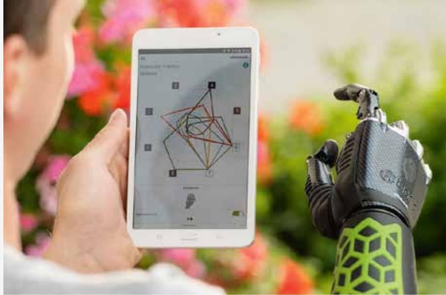
Das Orthopädietechnik-Unternehmen Ottobock hat eine KI-basierte Steuerung für eine Handprothese entwickelt. So lässt sich die Prothese beinahe wie eine echte Hand nutzen. Die Elektroden in der Prothese Myo Plus messen Bewegungsmuster in den Muskeln des Unterarmstumpfs – zum Beispiel beim Griff nach einer Wasserflasche oder beim Schnürsenkelbinden. Die Steuerung gibt der Prothese dann den Befehl, den passenden Griff oder die Rotation auszuführen. Das passiert automatisch.
